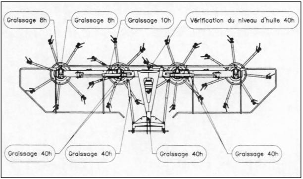
Figure 32 : tableau de graissage
