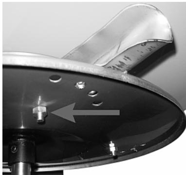
Svitare con una chiave il dado di fissaggio e sostituire l'elemento danneggiato.
